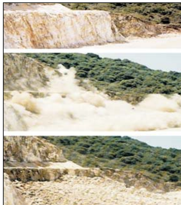
Fig. 6. Ruperea rocilor prin împușcare și așezarea materialului în grămadă în fața frontului de lucru
