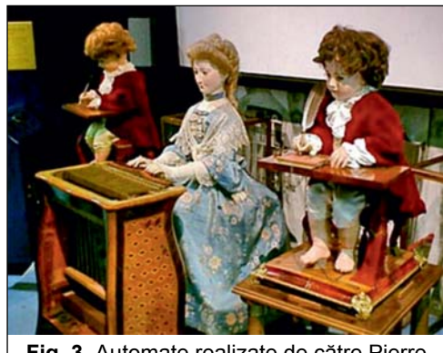
Fig. 3. Automate realizate de către Pierre Jaquet Droz, în anii 1768 – 1770: Scriitorul (în două variante) și Cântăreața la clavecin
