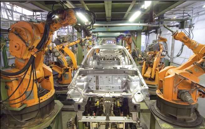
Linie de asamblare robotizată într-o uzină de automobile
